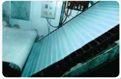
Hình b. Tráng bánh bằng máy
